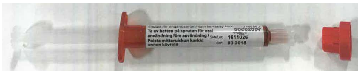
Figura 2. Dopo rimozione del cappuccio rosso, il cappuccio protettivo semitrasparente rimane sulla siringa (rimozione anormale riportata)
