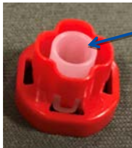
Figura 2. Dopo rimozione del cappuccio rosso, il cappuccio protettivo semitrasparente rimane sulla siringa (rimozione anormale riportata)
